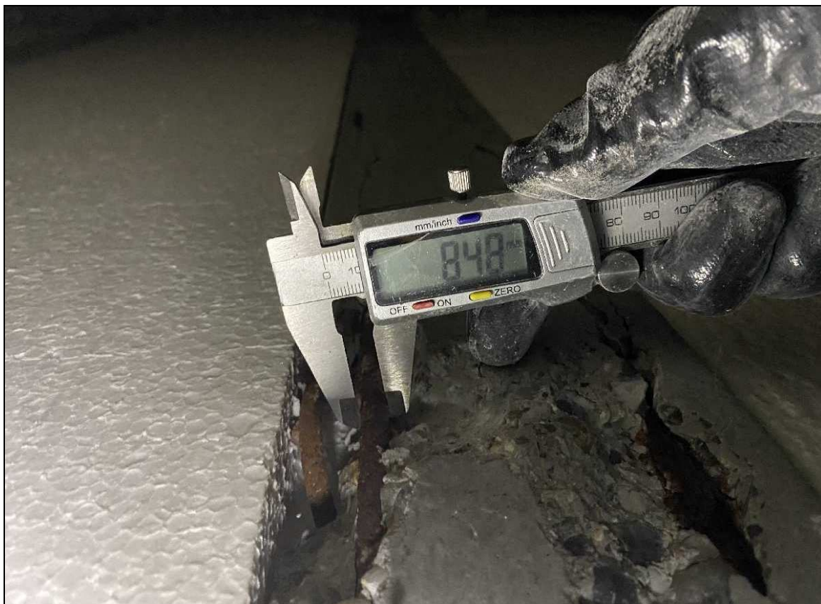
Photo n°44 : Foisonnement de l'armature
