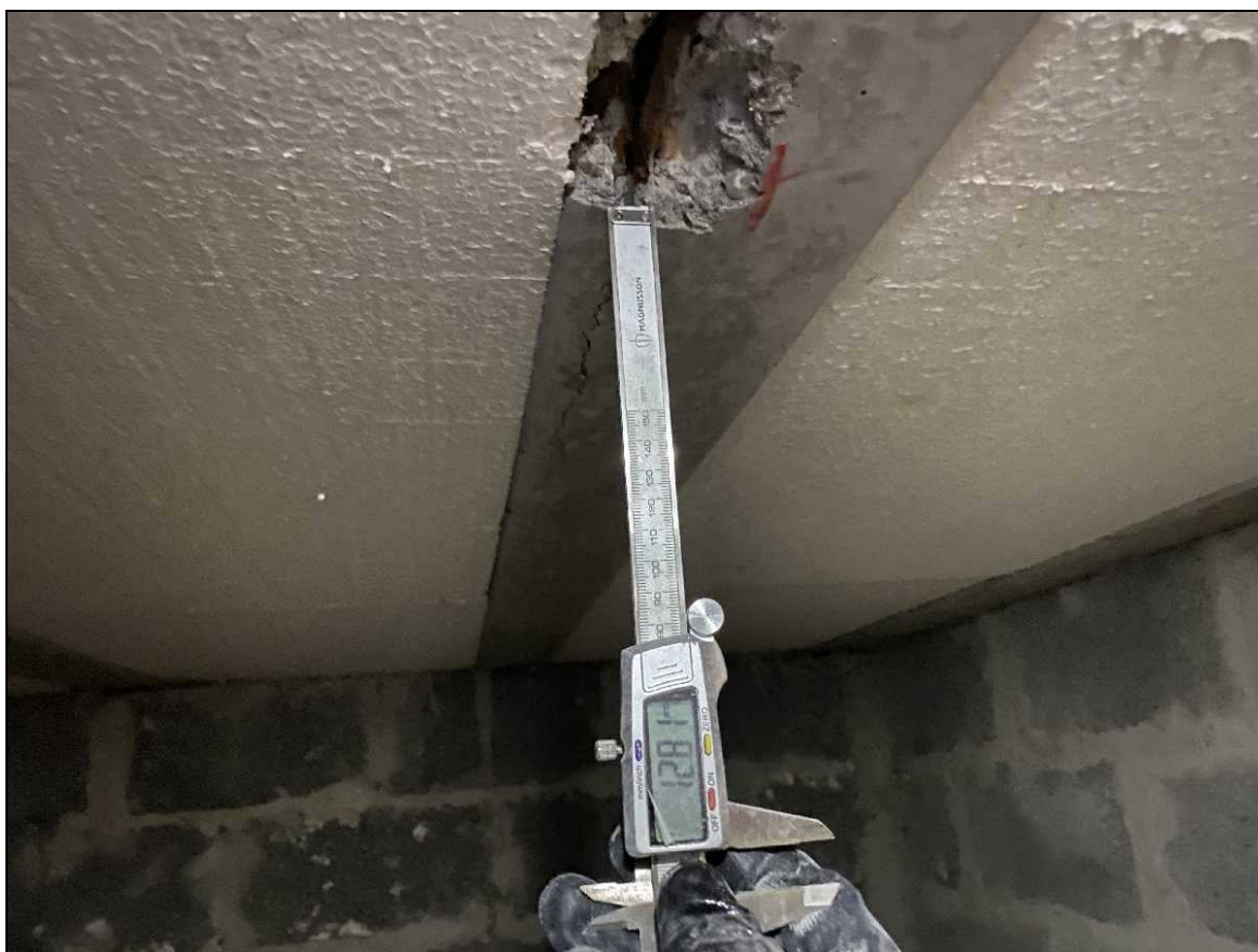
Photo n°45 : Enrobage faible (< 15 mm)
